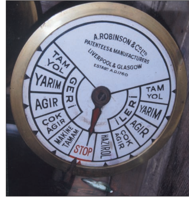
Kaptan, makinistlere ne yapacaklarını makine telgrafıyla işaret ederdi.
